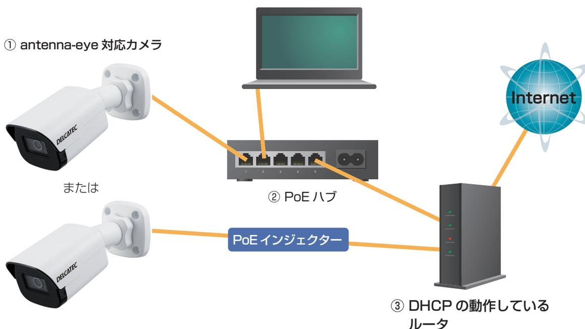
②が PoE ハブではない場合は、カメラとルーターの間に PoE インジェクターを設置するか、AC アダプターでカメラへ電源を供給してください。
