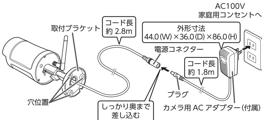
外形寸法からアンテナの高さを考慮し、アンテナが壁や天井に当たらないように設置してください。
