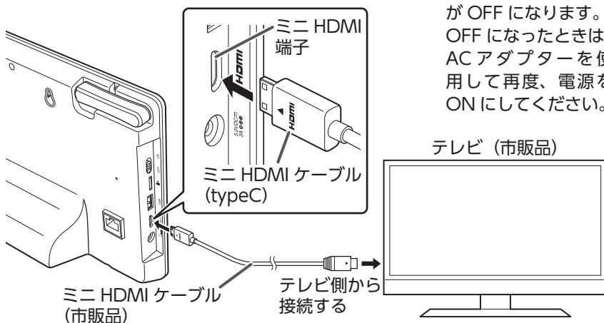
**重要** HDMI ケーブルが他の端子に接触すると液晶モニターの電源が OFF になります。OFF になったときは、AC アダプターを使用して再度、電源を ON してください。
