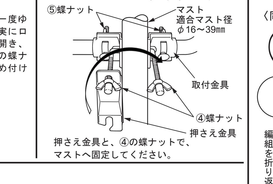
③の蝶ナットを一度ゆるめ反射器が確実にロックされるまで開き、固定した後に③の蝶ナットを確実に締め付けてください。
