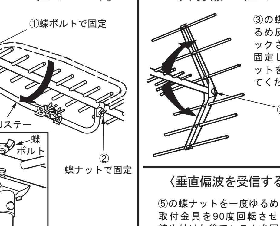
Uステーを矢印の方向へ約90度回転させ①の蝶ボルト、②の蝶ナットの順番でしっかりと固定してください。
