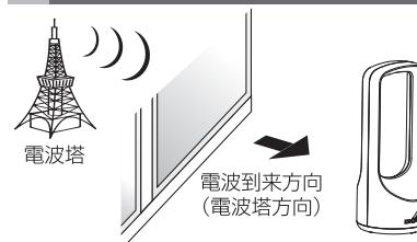
電波塔の方向にある窓ぎわなど、電波を強く受信できる場所にアンテナを設置してください。
