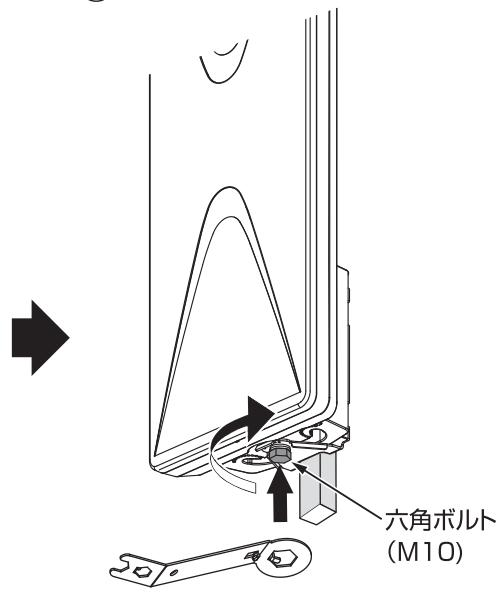
アンテナを向ける方向により、ボルト固定位置を選択してください。
