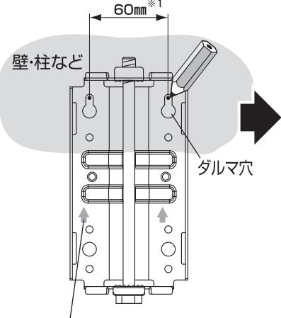
矢印の刻印が、必ず上向きになるよう取付金具を設置してください。
