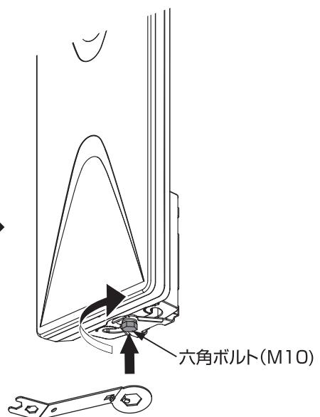
アンテナの方向調整を行なうため、アンテナ本体を手で動かせる程度に六角ボルト(M10)を軽く締めてください。
