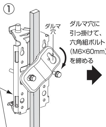
矢印の刻印が、必ず上向きになるように取付金具を設置してください。
