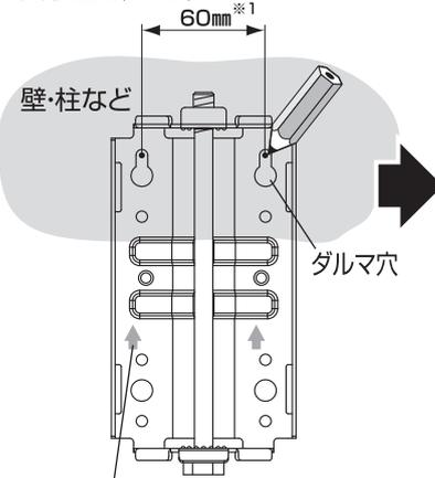
矢印の刻印が、必ず上向きになるように取付金具を設置してください。
