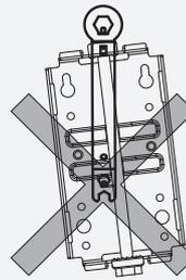
スパナとボルトが平行になっていない (スパナの先端の「切り欠き」に、ボルトがおさまって見えない)
