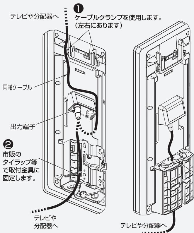
出力端子とテレビを接続する同軸ケーブルの固定方法は左図①~③の3つの方法から選択してください。
