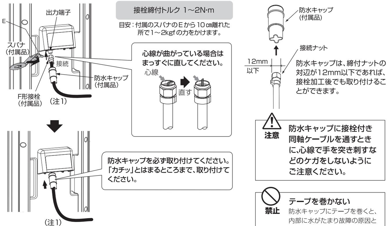
(注1) 5C相当同軸ケーブルの曲げ半径は、半径30mm以上になしてください。
