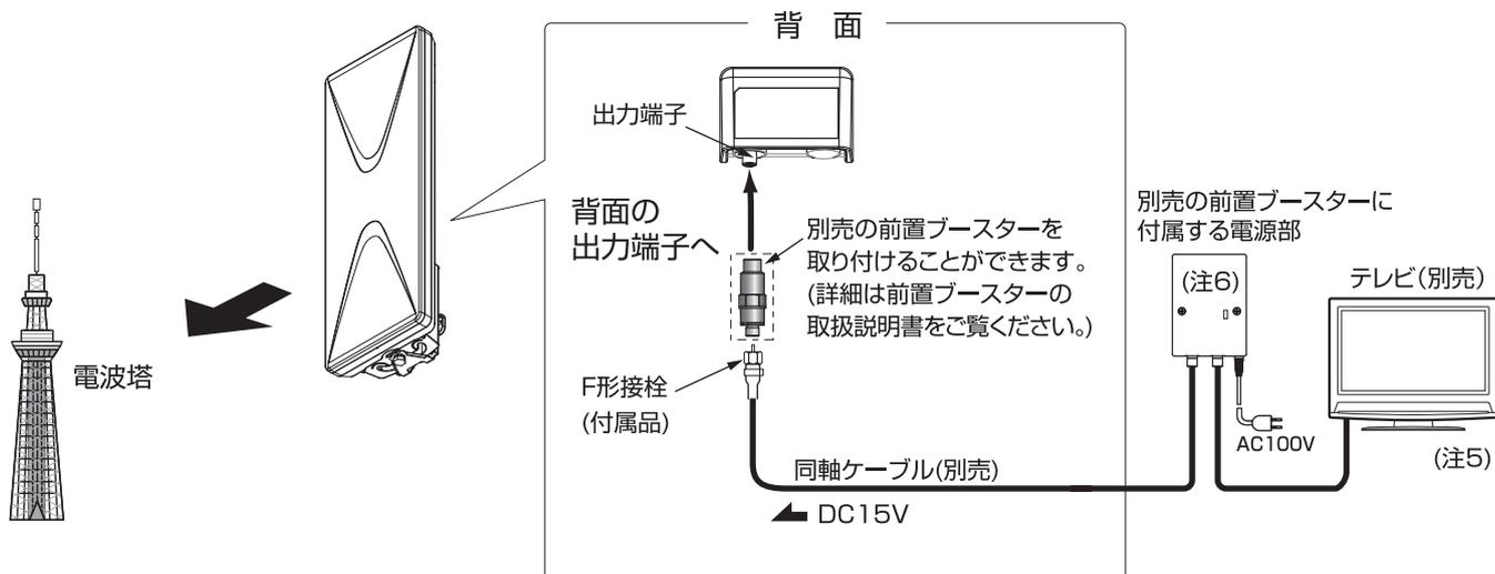
(注5) テレビのCS/BSコンバーター用電源の供給機能は「切」または「OFF」にしてください。ブースター用電源に電気が流れるとショート状態になり、テレビの保護回路がはたらいてテレビ画面が映らなくなり、エラーメッセージがでますのでご注意ください。
