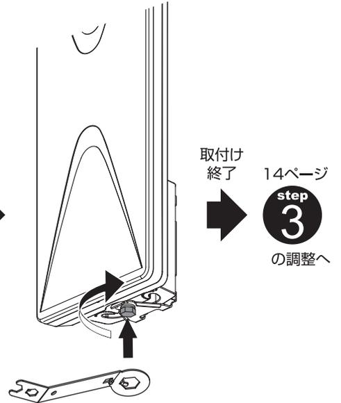
アンテナの方向調整を行なうため、アンテナ本体を手で動かせる程度に六角ボルトを軽く締めてください
