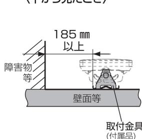
① 取り付ける壁面にネジ穴の印をつけてネジを取り付けます
