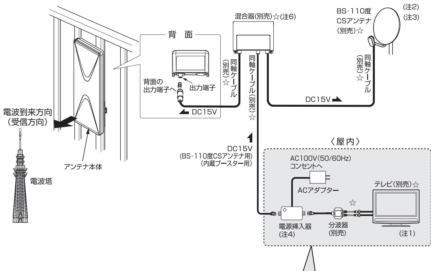
(注1)付属の電源挿入器は内蔵のブースターとBS・110度CSアンテナに電源を供給できます。テレビのCS/BSコンバーター用電源の供給機能は「切」または「OFF」にしてください。詳しくは接続する機器の取扱説明書をご覧ください。
