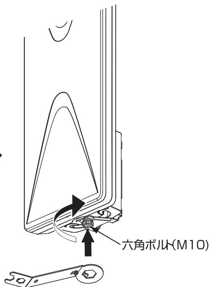
アンテナの方向調整を行なうため、アンテナ本体を手で動かせる程度に六角ボルト(M10)を軽く締めてください。
