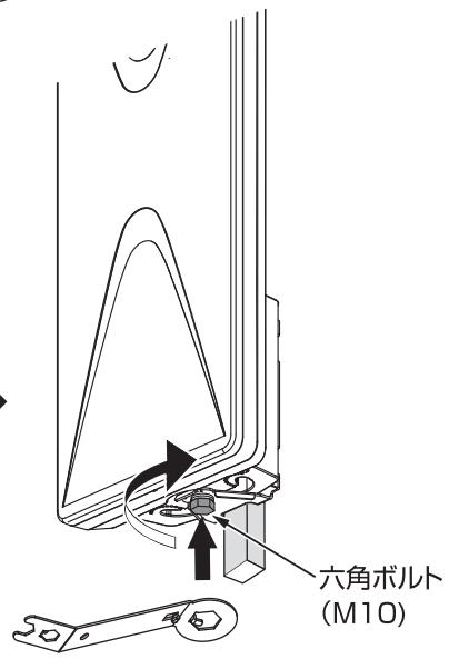
アンテナを向ける方向により、ボルト固定位置を選択してください。
