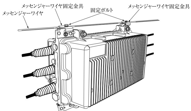
メッセンジャーワイヤは $\phi 5\sim\phi 11mm$  ( $20\sim95mm^2$ ) のワイヤを使用してください。
