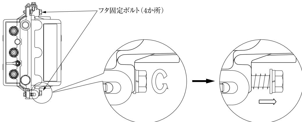
②ヒンジピンがヒンジ金具の先端に当たるまでダイカストケースフタを手前に引き出し、ゆっくりと開けてください。
