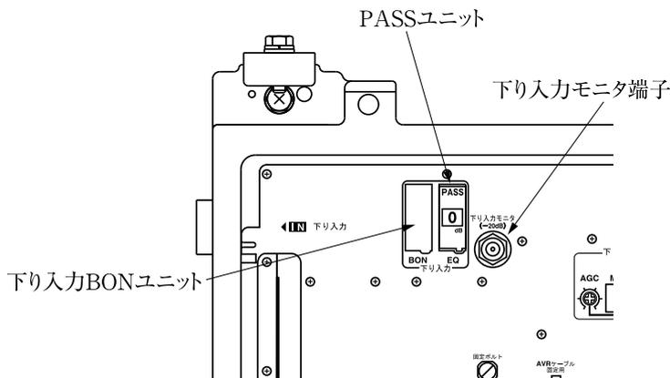
下り入力レベルは、付属のモニタ用コネクタを使用し、増幅部ユニットの下り入力モニタ端子で測定できます。この端子では入力BON、EQ後の信号が入力レベルより20dB低い値でモニタできます。
