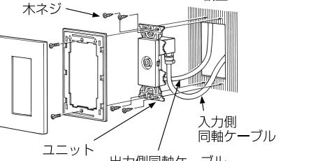
ユニット両端の取付サポートだ円穴を利用して木ネジまたは釘で左右上下4か所しっかりと取り付けてください。
