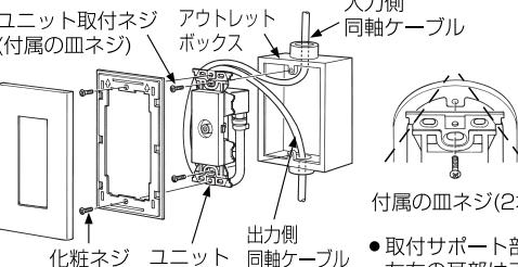
ユニット両端の取付サポートだ円穴を利用して付属の皿ネジで上下2か所しっかりと取り付けてください。
