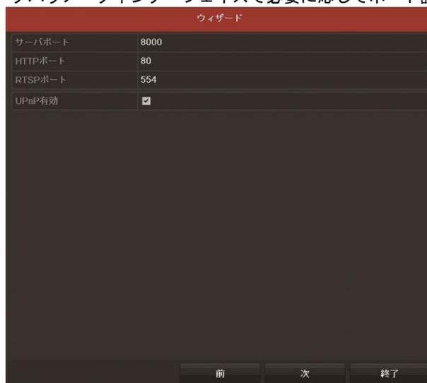
図 2.4-7 高度なネットワークパラメータの設定
