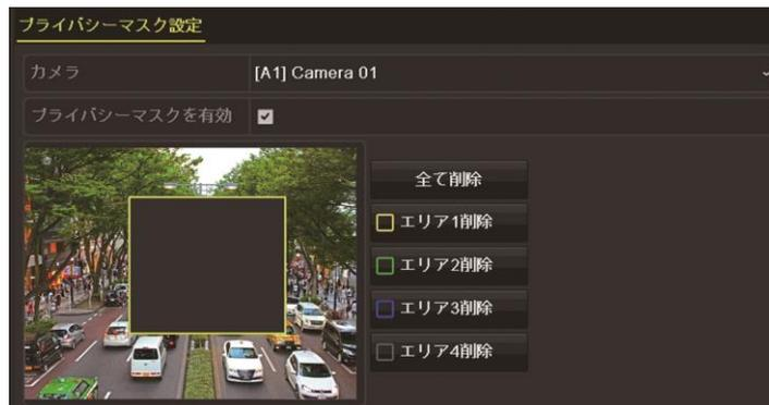
図 12.2-2 プライバシー マスク エリアの設定
