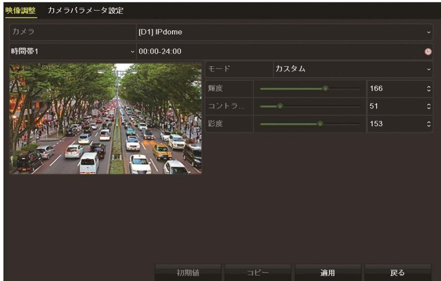
図 12.3-2 イメージ設定インターフェイス (IP カメラ)
