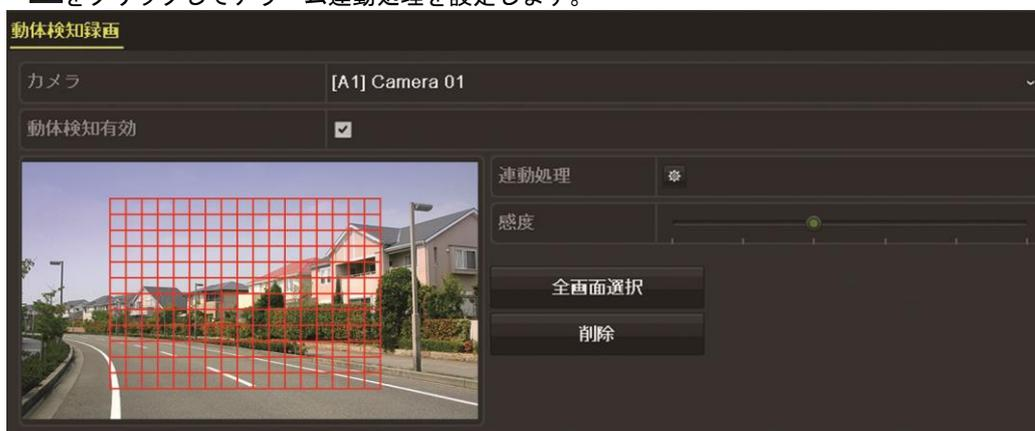
図 8.1-2 検知エリアと感度の設定
