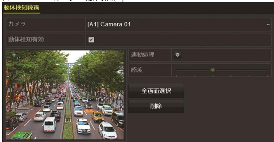
図 8.1-1 動体検知セットアップインターフェイス
