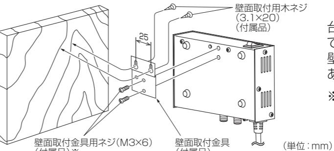
台の上に置くだけでなく、付属の壁面取付金具を利用して柱または板壁に取り付けることができます。
