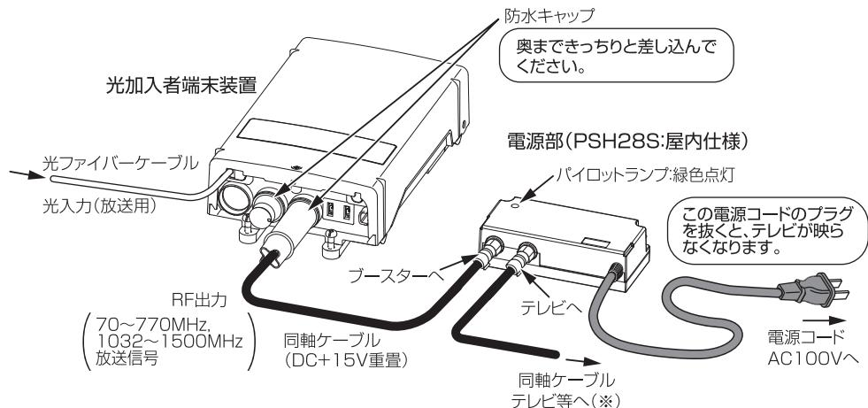
※テレビ、チューナー、HDDレコーダー等のCS/BSアンテナ電源を必ず「供給しない」または「OFF」に設定してください。
