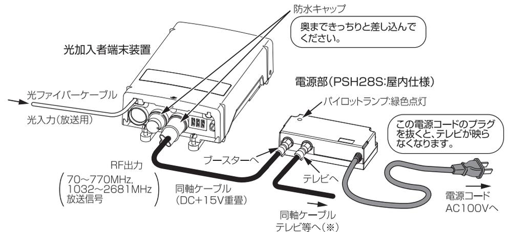
※テレビ、チューナー、HDDレコーダー等のCS/BSアンテナ電源を必ず「供給しない」または「OFF」に設定してください。
