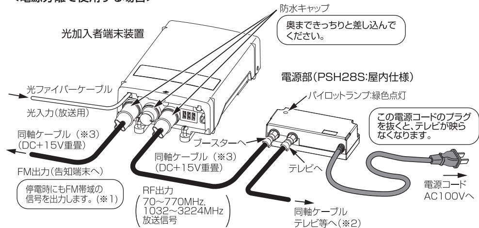
※1 FM帯域の信号出力端子を設定できる「FM切換えスイッチ」を備えています。
