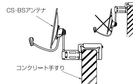
※アンテナを取付金具の下側に取り付けない
