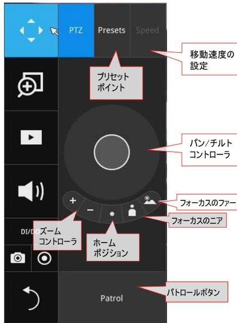
**PTZプリセット:** PTZカメラにプリセットポジションが登録されている場合、このボタンをクリックするとプリセットメニューが表示されます。任意のプリセットポジションをクリックするとポジションに移動します。
