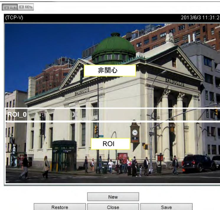
結果として、画面下部は高品質の細部を常に表示していますが、画面上部は低品質の形式で送信されます。上半分は低品質形式で送信されますが、画面全体では何が起きているかを認識できるようになっています。
