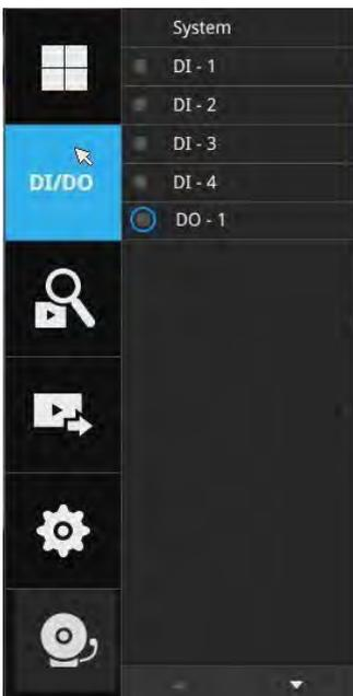
[DI/DO]ボタンをクリックすると、構成に含まれるすべてのカメラ(接続の有無を問わず)からのDIおよびDO信号の完全なリストが表示されます。左側のデジタル入力信号(例えばDI-4)がトリガーされると、インジケータが白色に点灯します。
