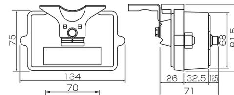
壁面取付ネジピッチガイド70mm(実寸)
