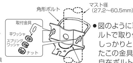
●図のように取付金具を角形ボルトで取り付け混合器本体をしっかりと固定ください。またこの金具はコン柱ボルトや自在ボルトにも取り付けることができます。
