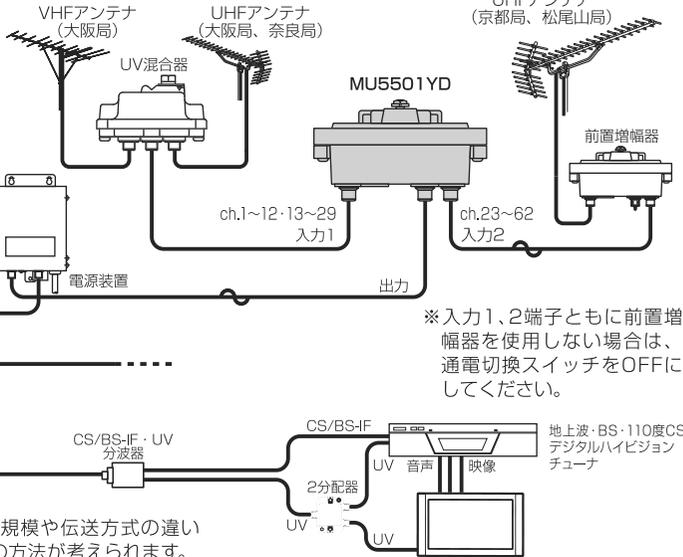
※入力1、2端子ともに前置増幅器を使用しない場合は、通電切換スイッチをOFFにしてください。
