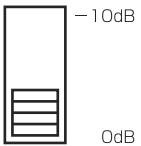
\*スイッチを切り換える場合、切換操作を数回行ない、スイッチ接点部の活性化(クリーニング)をしてください。
