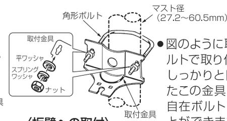
●図のように取付金具を角形ボルトで取り付け混合器本体をしっかりと固定ください。またこの金具はコン柱ボルトや自在ボルトにも取り付けることができます。
