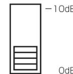
※スイッチを切り換える場合、切換操作を数回行ない、スイッチ接点部の活性化(クリーニング)をしてください。
