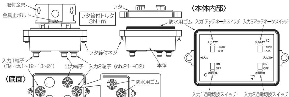
付属品 取付金具：1個、角形ボルト：1本、防水キャップ：3個
