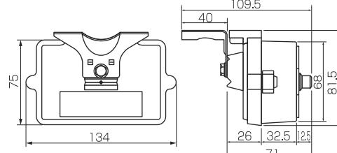
壁面取付ネジピッチガイド70mm (実寸)
