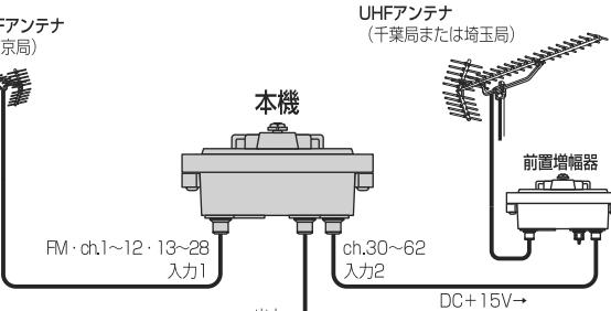
※入力1、2端子ともに前置増幅器を使用しない場合は、通電切換スイッチをOFFにしてください。
