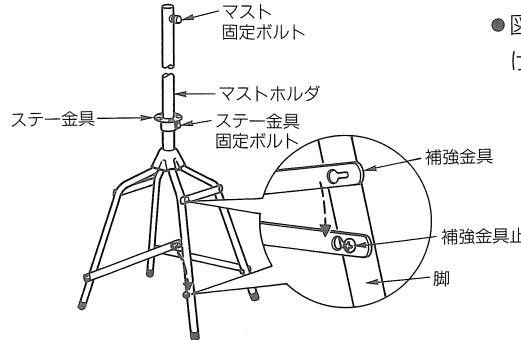
● 図のように脚を開き補強金具止めに引っかけてネジをしっかりと締め付けてください。
