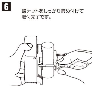
蝶ナットをしっかり締め付けて取付完了です。
