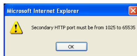
LAN上のネットワークカメラへのアクセスには、HTTPポートとセカンダリHTTPポートの両方を使用することができます。例えば、HTTPポートを80、セカンダリHTTPポートを8080に設定する場合の、ネットワークカメラのIPアドレスは次のようになります。
