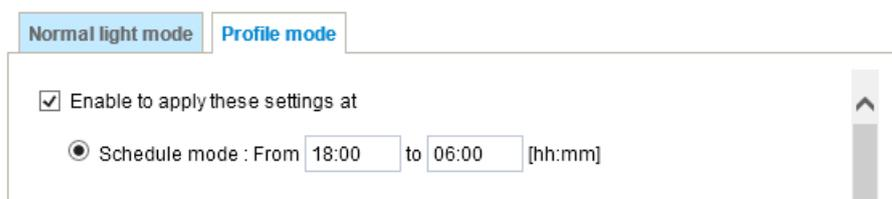
**設定の適用を有効にする**: このプロファイルを適用するモードとして、「スケジュールモード」を選択します。続いて、時間帯を手動で入力してください。[保存]をクリックして、設定を有効にします。
