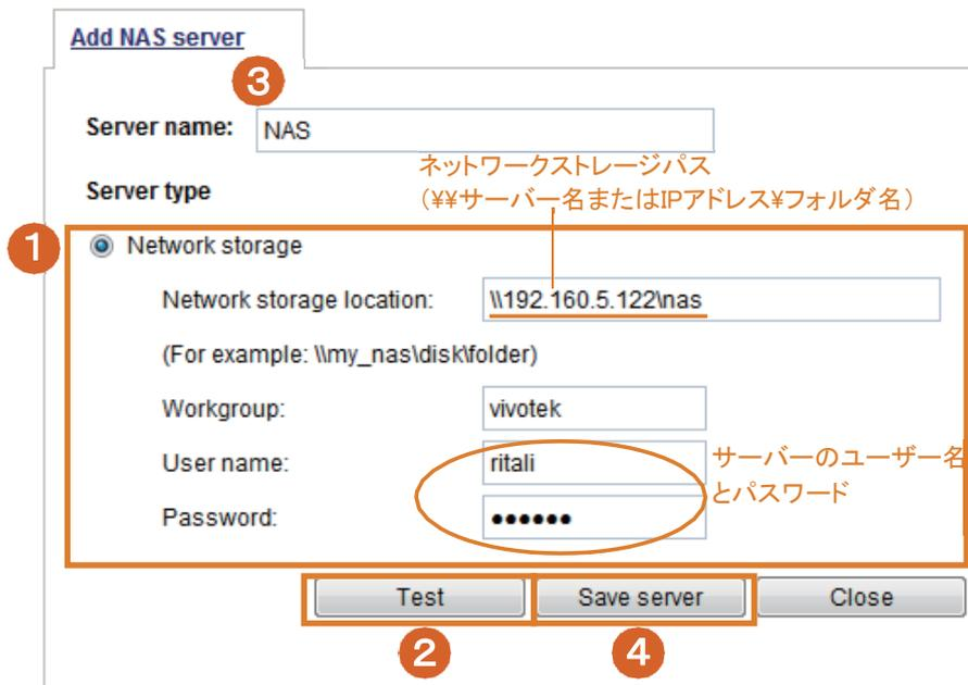
2. [テスト]をクリックして設定を確認します。結果はポップアップウィンドウに表示されます。
