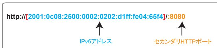
▶[ネットワークの種類]にPPPoEを選択した場合、[PPP0アドレス]はIPv6情報欄に次のように表示されます。
