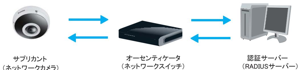
1. サブクライアント: 認証要求するクライアントエンドユーザー(カメラ)です。
