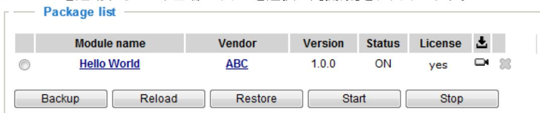
モジュールを解除する必要がある場合は、左端のボタンを選択し、[停止]をクリックします。モジュールが「オフ」になり、右端に[×]が表示されます。[×]をクリックすると削除されます。
