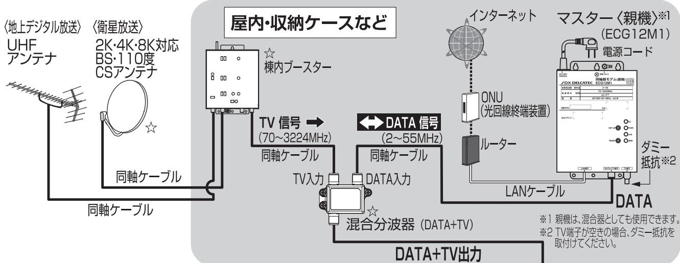
\*4K・8K放送(新4K8K衛星放送)を見るためには、4K・8K放送に対応したケーブルや☆印の機器(3224MHz)が必要です。
