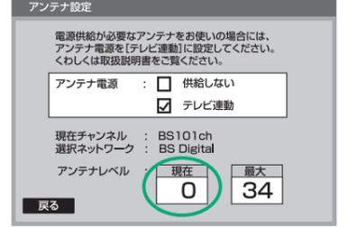
アンテナレベルは、2~3秒遅れて画面の表示が変わります。また、映像が映るまでは0のままで、信号を受信しはじめる急激に変化しますので、1cm程度動かしては止めて、動かしては止めてをくり返してください。
