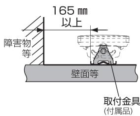
① 取り付ける壁面にネジ穴の印
