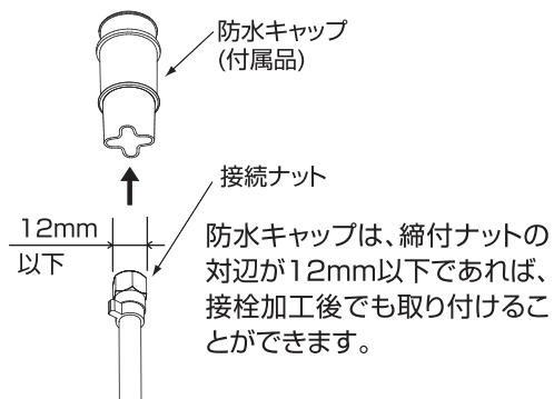
**注意** 防水キャップに接栓付き同軸ケーブルを通すときに、心線で手を突き刺すなどのケガをしないようにご注意ください。
