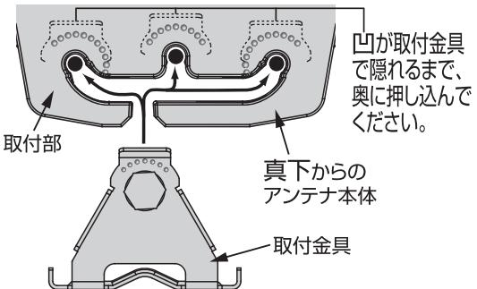
アンテナの方向調整を行なうため、アンテナ本体を手で動かせる程度に六角ボルトを軽く締めてください
