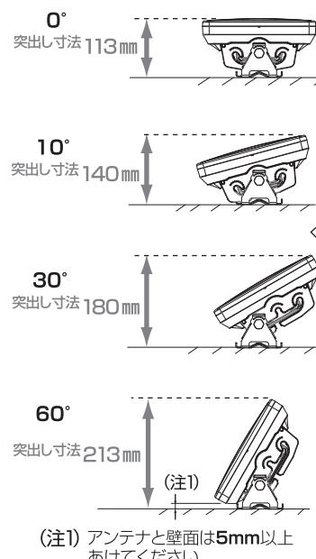
アンテナを10°を超えて傾ける場合、両サイドの固定位置を使用します。アンテナ本体を下図のように溝に沿ってスライドさせてください。
