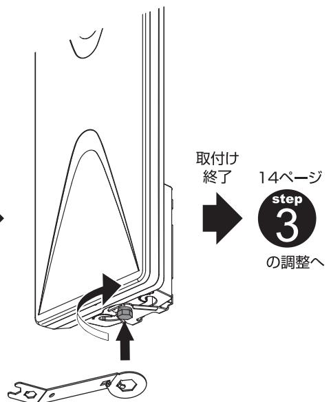
アンテナ本体を向ける方向により、ボルト固定位置を選択してください。
