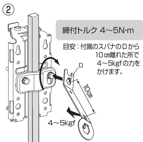
矢印の刻印が、必ず上向きになるように取付金具を設置してください。
