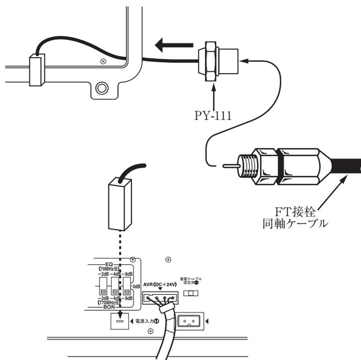
※給電用ケーブルには、JIS規格ケーブル（JIS C3503、8C以上のパイプケーブル）をご使用ください。
