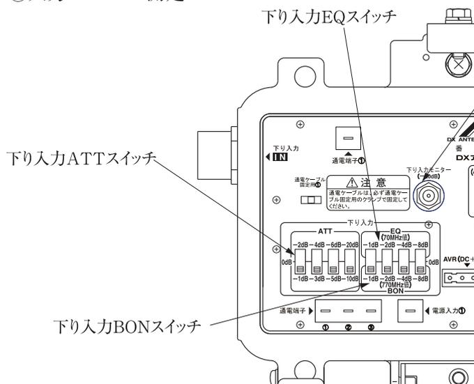
下り入力レベルは、増幅部ユニットの下り入力モニター端子で測定できます。この端子では入力BON、EQ、ATT後の信号が入力レベルより20dB低い値でモニターできます。
