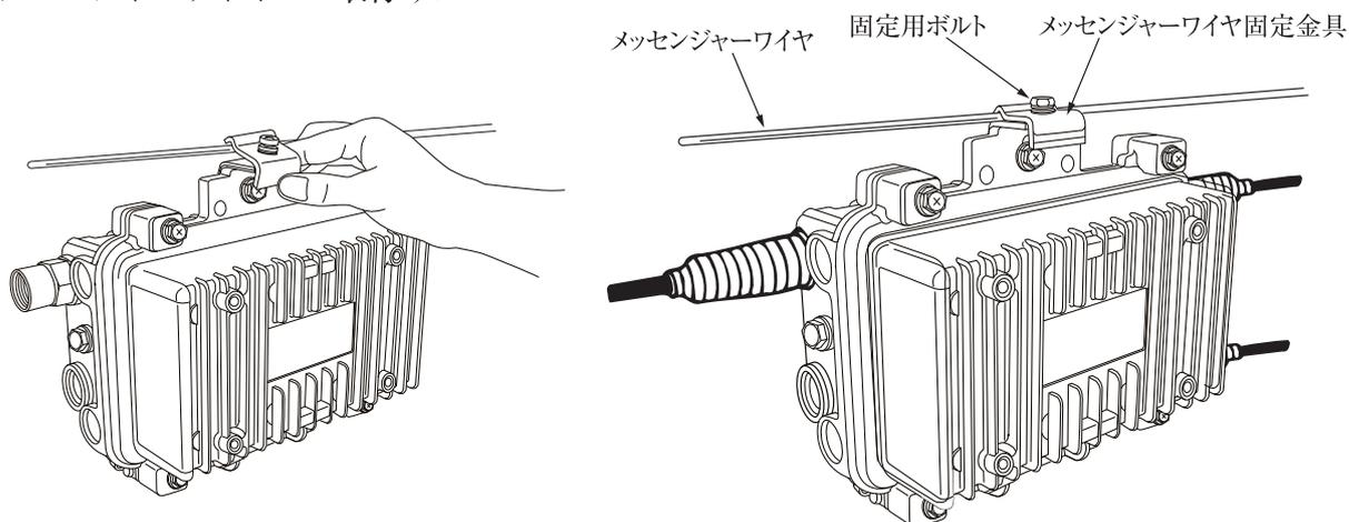
メッセンジャーワイヤは $\phi 5 \sim \phi 11\text{mm}$  ( $20 \sim 95\text{mm}^2$ ) のワイヤを使用してください。
