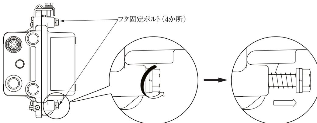
②ヒンジピンがヒンジ金具の先端に当たるまでダイカストケースフタを手前に引き出し、ゆっくりと開けてください。
