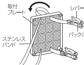
②パックルがマストの真後ろにくるようにステンレスバンドの長さを調整してください。
