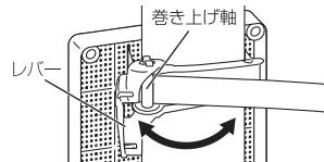
⑥ステンレスバンドの不要部分を、巻き上げ軸から約3~4cmを残して、金切りばさみでカットして下さい。(切断面が鋭い部分がありますのでご注意ください)
