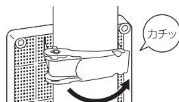
⑧機器付属またはネジ径φ3~4.5mmのネジで機器をプレート板に固定してください。
