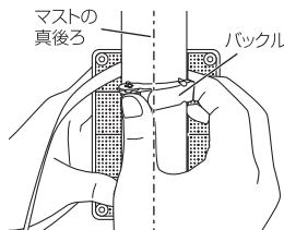
③ステンレスバンドの先端を巻き上げ軸の差し込み穴に通してください。
