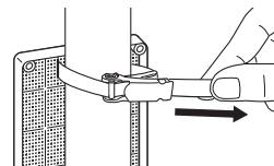
⑤レバーの開閉を繰り返すと、巻き上げ軸が回転し、ステンレスバンドが締まります。
