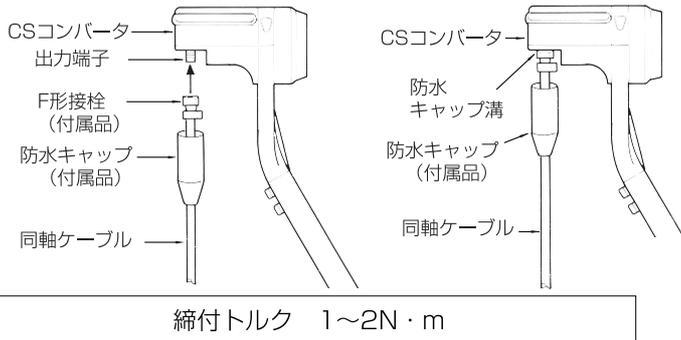
②同軸ケーブルに通しておいた防水キャップをずらしてCSコンバータの防水キャップ溝に防水キャップを差し込んでください。
