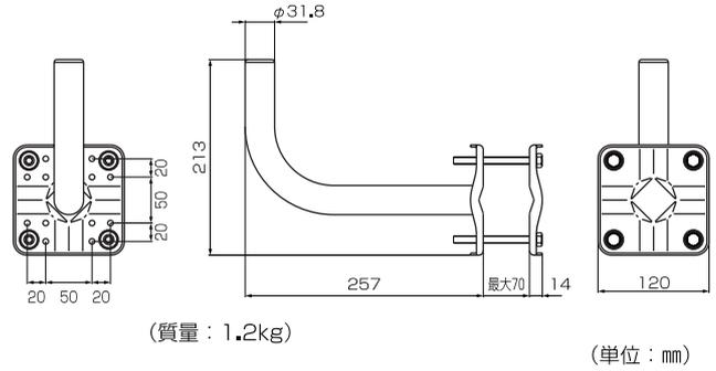
寸法はアンテナ仰角が40° ポール径φ31.8mmの場合の
