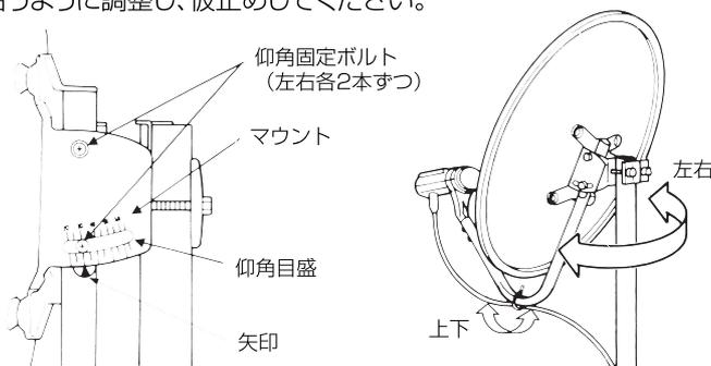
※最終的に正確な仰角・方位角の調整は、衛星からの電波を受信して行います。
