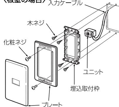
• ワイドプレートに取り付ける場合は、ワイド対応の取付枠を使用してください。
