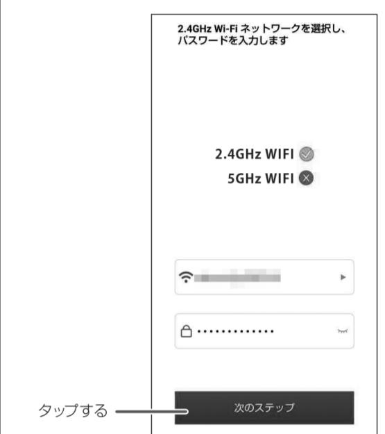
**ご注意** ・本製品は2.4GHz帯の無線LANルーターに接続して使用してください。5GHz帯の無線LANルーターには接続しないでください。
