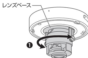
垂直方向に調整する場合は、左右の固定ネジを少し緩め、レンズユニット部の角度を調整します (2)。
