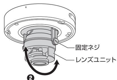
映像の上下方向が正しくなるようレンズユニット部を回転させます (3)。
