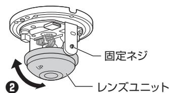
映像の上下方向が正しくなるようレンズユニット部を回転させます (③)。
