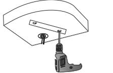
3. コンクリートアンカー2本をガイド穴に打ち込み、しっかりと固定されていることを確認します。
