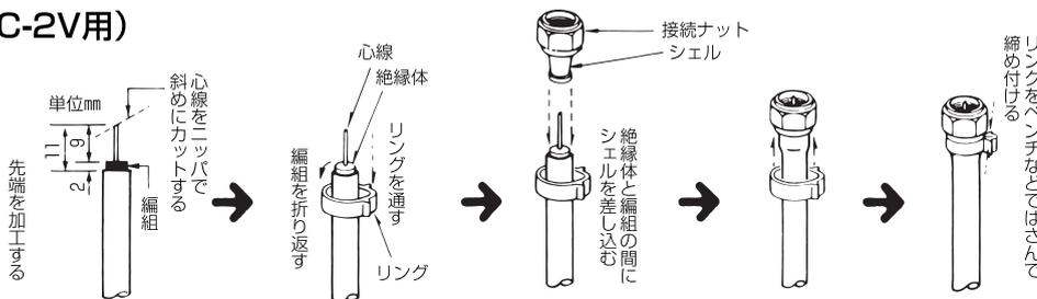
接栓締めトルク  $2\text{N}\cdot\text{m}$
