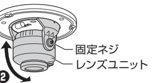
垂直方向に調整する場合は、左右の固定ネジを少し緩め、レンズユニット部の角度を調整します (②)。調整後、緩めた固定ネジを締め付けてください。
