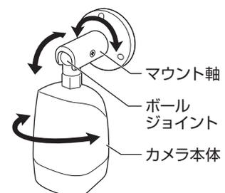
2) カメラを目的の監視方向に向け、調整した角度や方向がずれないように注意しながら、調節ネジをしっかりと締め付けます。
