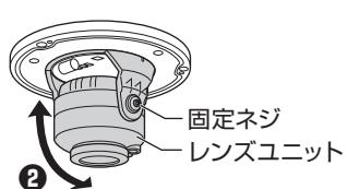
垂直方向に調整する場合は、左右の固定ネジを少し緩め、レンズユニット部の角度を調整します（②）。調整後、緩めた固定ネジを締め付けてください。
