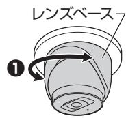
垂直方向に調整する場合は、レンズユニット部の角度を調整します（②）。
