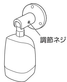
**5** すべてのケーブルを接続し、カメラを壁面に取り付けます。取り付け用の穴位置とベースの穴位置を合わせて、取付ネジ 3 本 (付属品) をドライバーで締めつけて固定します。
