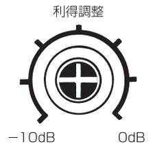
※利得調整ボリュームは、調整用ドライバーで軽く回してください。強く回すとボリュームが破損する恐れがあります。
