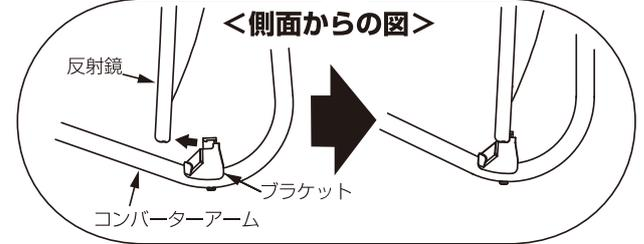
1-3 プラケットをはめ込んだ後にコンバーターアーム取付用ボルト(M6) 2本を指定のトルクで固定してください。
