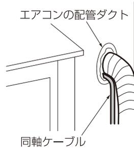
同軸ケーブルの先端が傷つかないように、市販のビニルテープなどで保護し、配管ダクトに通します。
