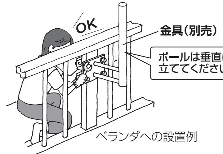
金具を壁面に設置する場合は、壁面の強度が強風等に耐えられるネジや釘等をご使用ください。
