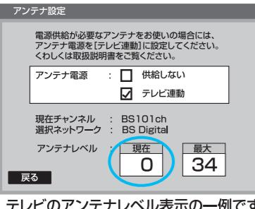
アンテナレベルは、**2~3秒遅れて**画面の表示が変わります。また、映像が映るまでは0のままで、信号を受信しはじめるとき激に変化しますので、1cm程度動かしては止めて、動かしては止めてをくり返してください。
