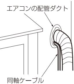
同軸ケーブルの先端が傷つかないように、市販のビニールテープなどで保護し、配管ダクトに通します。
