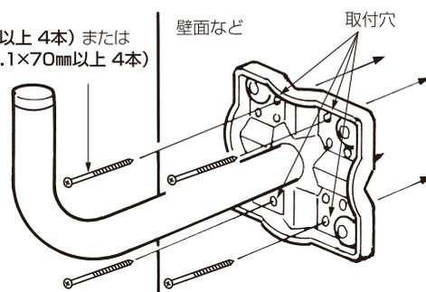
(注) 壁面に取り付ける場合は、壁面の強度がわかる工務店にご相談のうえ、適したネジをご使用ください。
