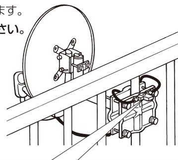
下図のようにインジケータに付属のケーブルを接続します。
