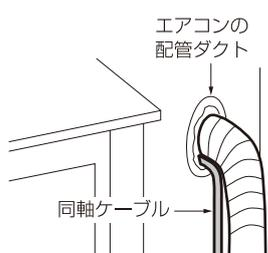
同軸ケーブルの先端が傷つかないように、付属のビニルテープなどで保護し、配管ダクトに通します。
