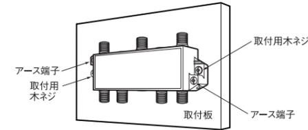
図のように、板壁または収容ボックスの取付板に、取付用木ネジで取り付けてください。
