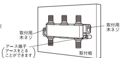
図のように、板壁または収容ボックスの取付板に、付属の取付用木ネジで取り付けてください。
