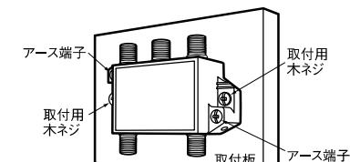
図のように、板壁または収容ボックスの取付板に、取付用木ネジで取り付けてください。
