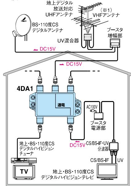
注) BS・110度CSアンテナにブースタ等別の電源から電源を供給するときは地上・BS・110度CSデジタルハイビジョンチューナーのBS-110度CSアンテナへの電源供給設定を常時OFFにしてください。(使用例の場合)
