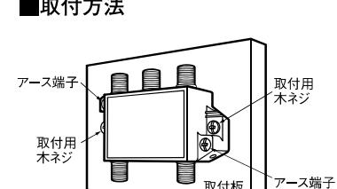
図のように、板壁または収容ボックスの取付板に、取付用木ネジで取り付けてください。
