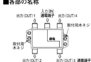
● 図中の矢印⇒はFMラジオ、およびTV信号の流れを示します。
