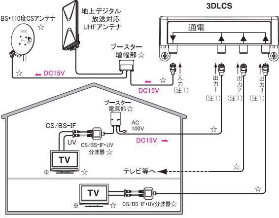
すべての出力端子から入力端子方向へ通電できます。ブースター電源部は出力2、出力3のいずれかの系統に設置することもできます。
