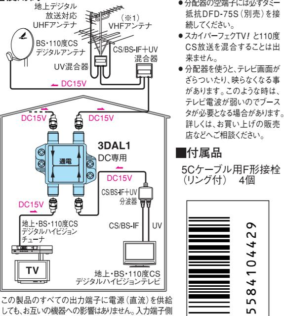
●この製品のすべての出力端子に電源(直流)を供給しても、お互いの機器への影響はありません。入力端子側には電圧の高い電源(直流)が供給されます。
