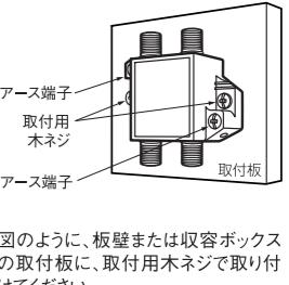
図のように、板壁または収容ボックスの取付板に、取付用木ネジで取り付けてください。
